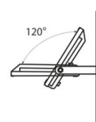
4. Закрепите болты кронштейна для фиксации прожектора
