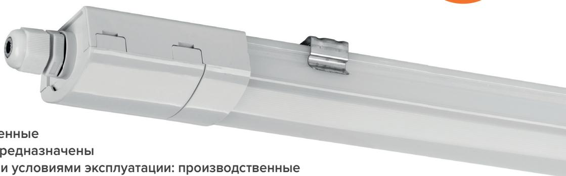
Линейные пылевлагозащищенные светильники серии WPL-01 предназначены для помещений с различными условиями эксплуатации: производственные и складские помещения, автосервисы, парковки, бытовые и хозяйственные постройки и т.д. Светильники имеют магистральную проводку, которая предусматривает возможность шлейфового соединения нескольких приборов.
