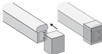
На незадействованные концы ленты необходимо установить силиконовые заглушки (в комплекте поставки). При установке заглушки, для обеспечения герметизации, рекомендуется использовать специальный клей-герметик.
